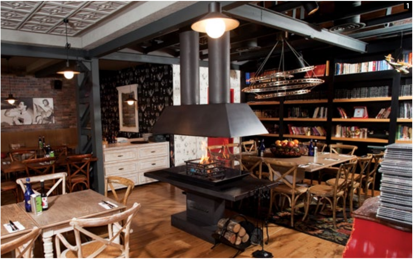
1 Çelik Gövdeli ve Bacalı, Döküm Yanma Hazneli, Özel Tasarım Orta Şömine.
